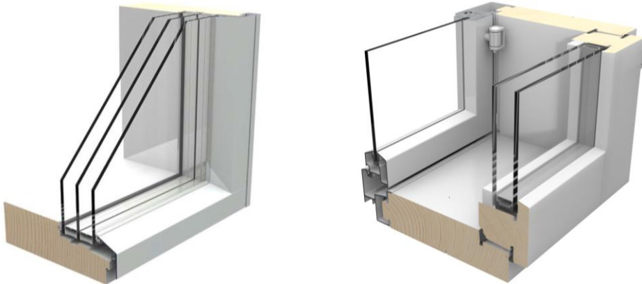
Kuva 1. Vasemmalla kiinteä ikkuna PihlaPro MEK-A puu-alumiini-ikkuna kolminkertaisella eristyslaselementillä. Oikealla kaksipuitteinen PihlaPro MSE1-A puu-alumiini-ikkuna, jossa sisäpuitteessa on kaksinkertainen eristyslaselementti.
