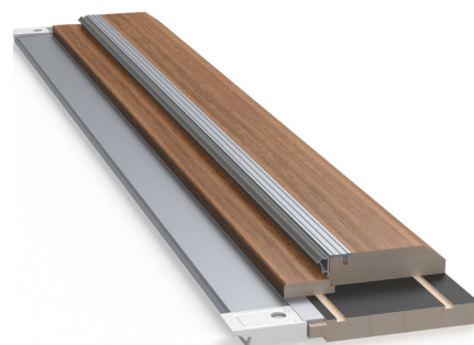
Lisävarusteena kynnysratkaisu, joka koostuu alaosan vanerista ja alumiinilistasta sekä jälkepäin asennettavasta JA-kynnyksestä. JA-kynnys on ruskeaksi kuultokäsiteltyä koivua, (kuva vasemmalla) jossa alumiininen kulutuslista. Tilauksesta lakattu tammi (keskellä) ja valkolakattu tammi (oikealla).
