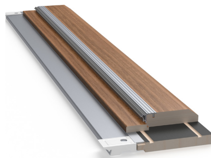
Lisävarusteena kynnysratkaisu, joka koostuu alaosan vanerista ja alumiinilistasta sekä jälkepäin asennettavasta JA-kynnyksestä. JA-kynnys on koivua, jossa alumiininen kulutuslista. Tilauksesta tammi.
