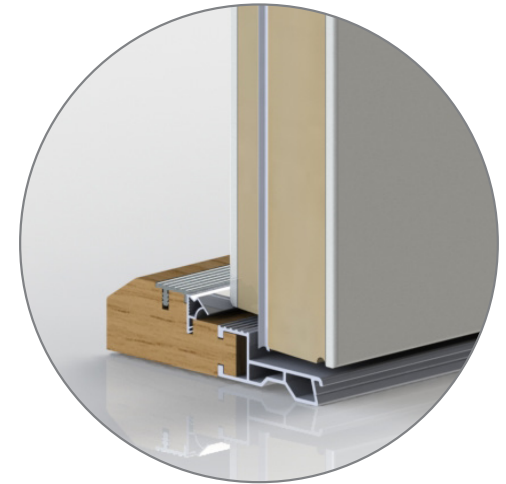
Tippanokka eli vesiura ohjaa veden pois ovilehdestä. Vesipelti on helppo kiinnittää kynnykseen.
