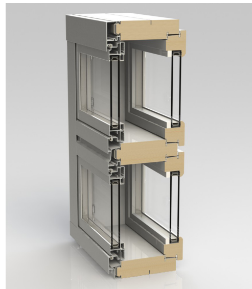
MSE2-A -ikkunan molemmissa puitteissa on eristyslasit.
